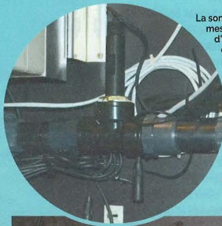
La sonde en haut mesure le potentiel d'oxydo-réduction de l'eau, les deux sondes en bas mesurent le pH et la conductivité. La qualité des sondes (Hanna Instruments) garantit la fiabilité des mesures.
